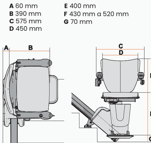
Las dimensiones pueden variar según el ángulo de las escaleras y la instalación específica.
